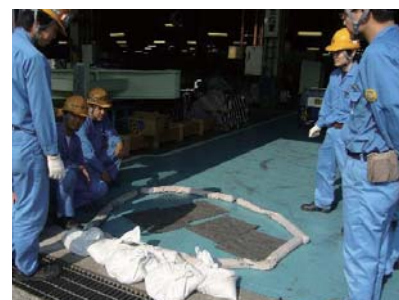
組立工場での作動油流出処置の対応
