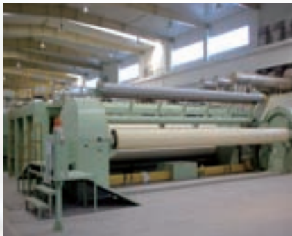
納入した二軸延伸ポリプロピレンフィルム製造装置 (写真は巻取機)
