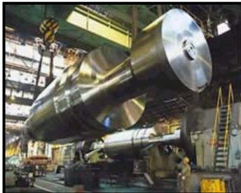
発電用タービン・発電機軸材
