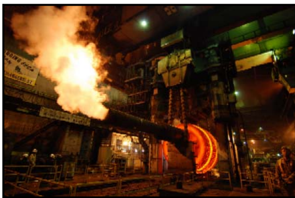
鋼塊を鍛錬・熱処理・旋盤加工等の加工を行い、製品に仕上げる(写真はプレス機を用いた鍛錬作業)
