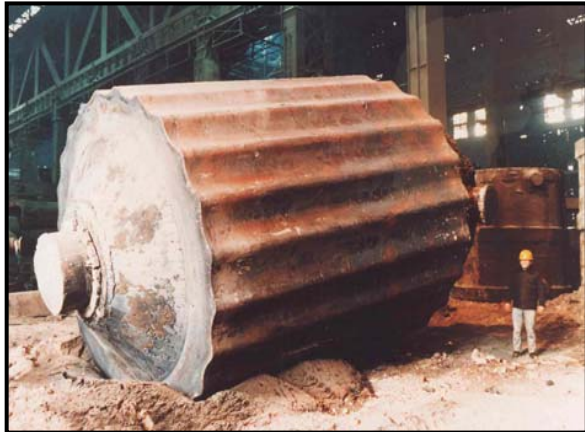
鋼塊：鍛鋼製品の素材(写真は世界最大600t鋼塊)
