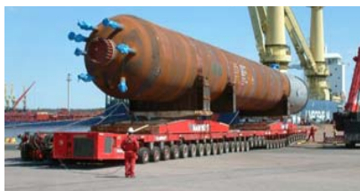
石油精製用大型圧力容器
