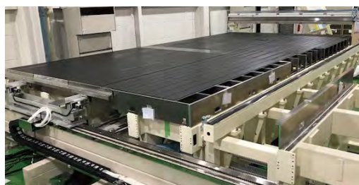
大型基板用フロートステージ Float-type stage for large substrates
