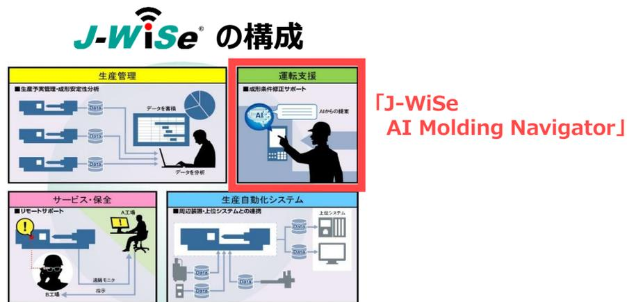
射出成形業界では、循環型社会実現のためにリサイクル材を有効活用する動きが強まっています。製品あたりのリサイクル材の含有量が増えることで、樹脂の粘度変化に起因した成形不良が発生しやすくなる課題があります。「J-WiSe AI Molding Navigator」(以下、「M-Navi.」)は、このような経時的な条件変化に伴う生産環境において、成形不良が発生する前、あるいは不良発生後に、射出成形機に接続した AI が良品を成形するための成形条件を提案し、修正を支援するシステムです。
